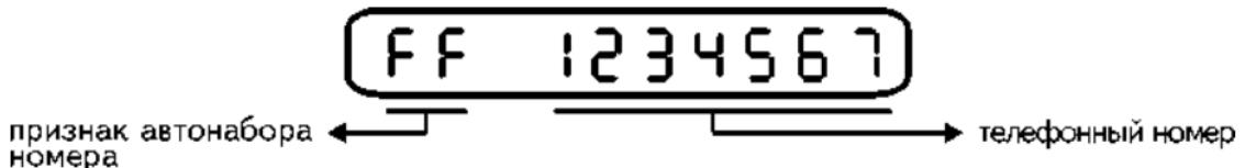
Набираемая цифра телефонного номера мигает. Нажав клавишу "C" можно остановить автонабор. После окончания набора номера весь индикатор начнет мигать. В это время Вы можете поднять телефонную трубку. Если трубка не поднята в течение 30 секунд, то аппарат вернется в основное состояние.
