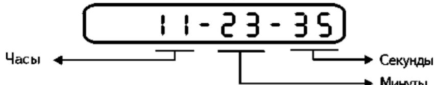
В этом режиме можно произвести установку часов. Клавишей "А" выбирается корректируемый разряд, "В" - производится установка (корректируемый разряд мигает). Выход из режима "Часы" в основное состояние производится клавишей "С".
