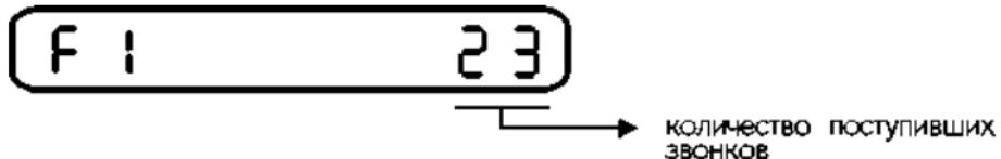
Счетчик считает число поступивших звонков от последнего сброса счетчика. Емкость счетчика 99 звонков. Сброс счетчика производится нажатием "D", выход в основное состояние клавишой "С". При сбросе счетчика поступивших звонков с экрана индикатора стирается отображаемый в основном состоянии телефонный номер.
