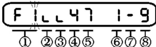
Переход от одного параметра к другому осуществляется нажатием "С", коррекция нажатием "Д". Корректируемый параметр мигает. Выход в основное состояние осуществляется удержанием клавиши "С" более 1 секунды.
