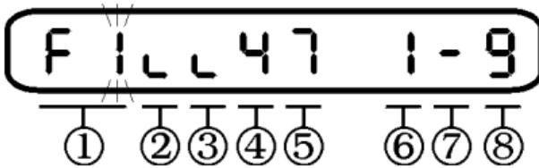
Переход от одного параметра к другому осуществляется нажатием "**▲**", коррекция нажатием "**▼**". Корректируемый параметр мигает. Выход в основное состояние осуществляется удержанием клавиши "**▲**" более 1 секунды.
