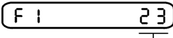
Счетчик считает число поступивших звонков от последнего сброса счетчика. Емкость счетчика 99 звонков. Сброс счетчика производится нажатием "▼", выход в основное состояние клавишой "▲". При сбросе счетчика поступивших звонков с экрана индикатора стирается отображаемый в основном состоянии телефонный номер.
