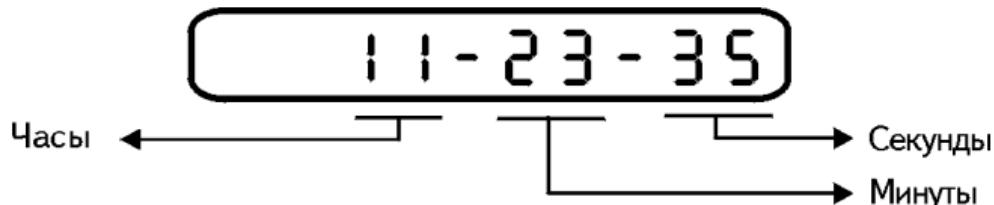
В этом режиме можно произвести установку часов. Клавишей " $\odot$ " выбирается корректируемый разряд, " $\square$ " - производится установка (корректируемый разряд мигает). Выход из режима "Часы" в основное состояние производится клавишей " $\blacktriangle$ ".
