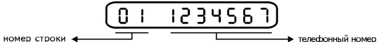
Телефонный номерзывающего абонента сразу же после определения заносится в эту "записную книжку", в строку с номером 01. Предпоследний звонок помещается в строку с номером 02 и т. д.
