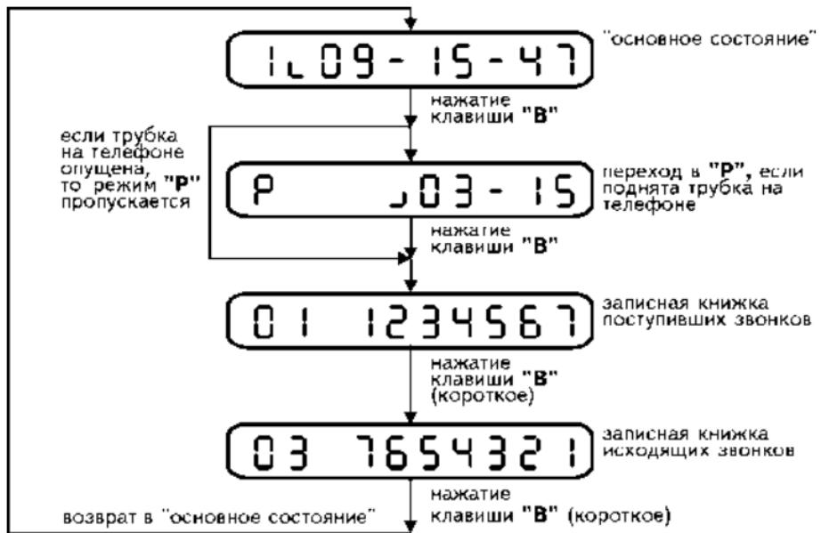
Переход из записной книжки поступивших звонков в записную книжку исходящих и выход в "основное состояние" производится коротким нажатием на клавишу "В" (не более 1 секунды).
