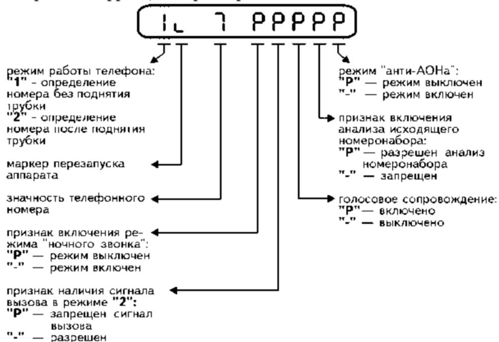
Переход от одного параметра к другому производится клавишей "С", изменение параметров клавишей "В". Корректируемый в данный момент параметр мигает.
