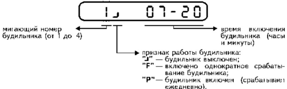
Номер будильника мигает указывая на то, что производится выбор будильника. Номер последовательно перебирается нажатием на клавишу "С". Нажав "В" Вы перейдете в режим установки параметров будильника: начнет мигать признак работы будильника. Признак работы можно изменить нажатием клавиши "В".
